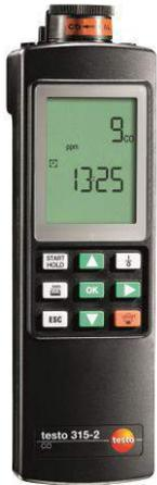
Instrumento de servicio y aviso de CO para sistemas de calefacción a gas
